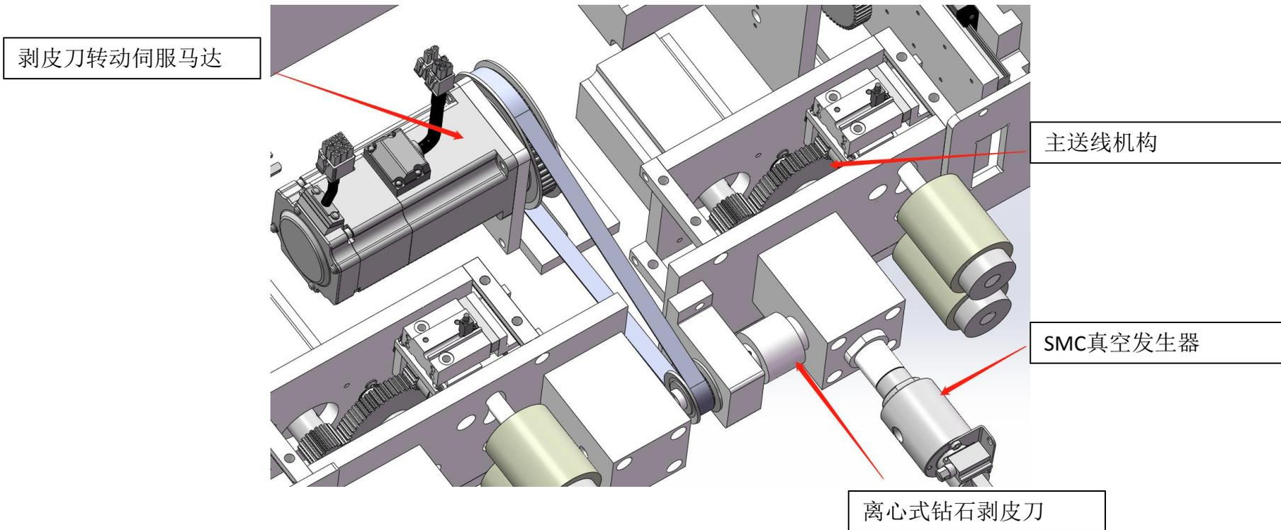
动作说明：伺服马达带动剥皮刀高速旋转（9000 R/Min），进行剥皮去漆，皮膜残渣通过真空发生器抽走。
