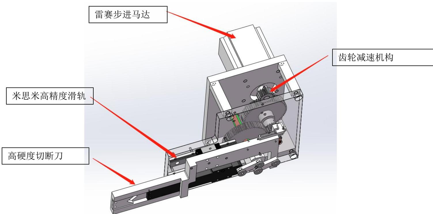
动作说明：步进马达控制切断刀进行切线裁断。
